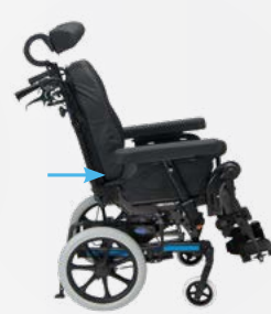
Il sistema brevettato DSS, con il punto di giunzione dello schienale al livello del trocantere, riduce al minimo lo scivolamento durante la reclinazione
